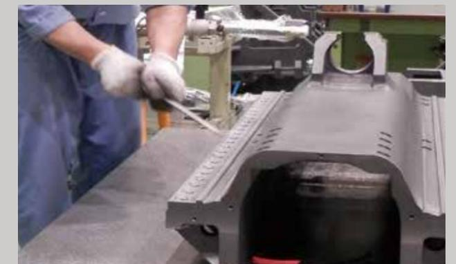
高精度の要となる『キサゲ』はX、Y、Z各軸のガイド取付け面に施されている。
