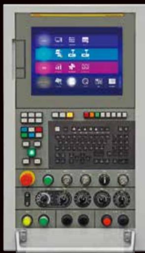
機上測定やツール情報、機械状態情報を容易に使用できるPANEL i-H Proが標準NCとして搭載されます。NC装置はパソコン機能内蔵のFANUC PANEL iH Pro仕様のFANUC Series 31i-MODEL B5(タッチパネル式15"LCD)を採用。さまざまなアプリケーションの展開が可能です。また、セレクトアスイッチやオーバーライドスイッチ等、アナログ感覚も重視し操作性の向上につなげています。
