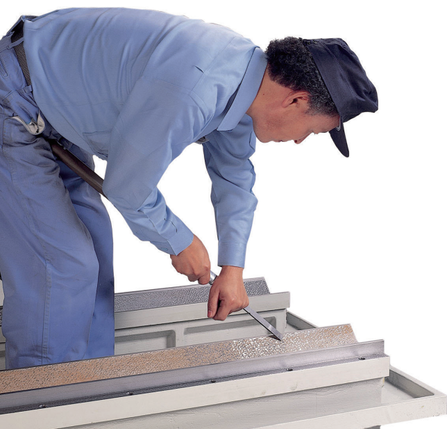
キサゲ加工による精度出し
