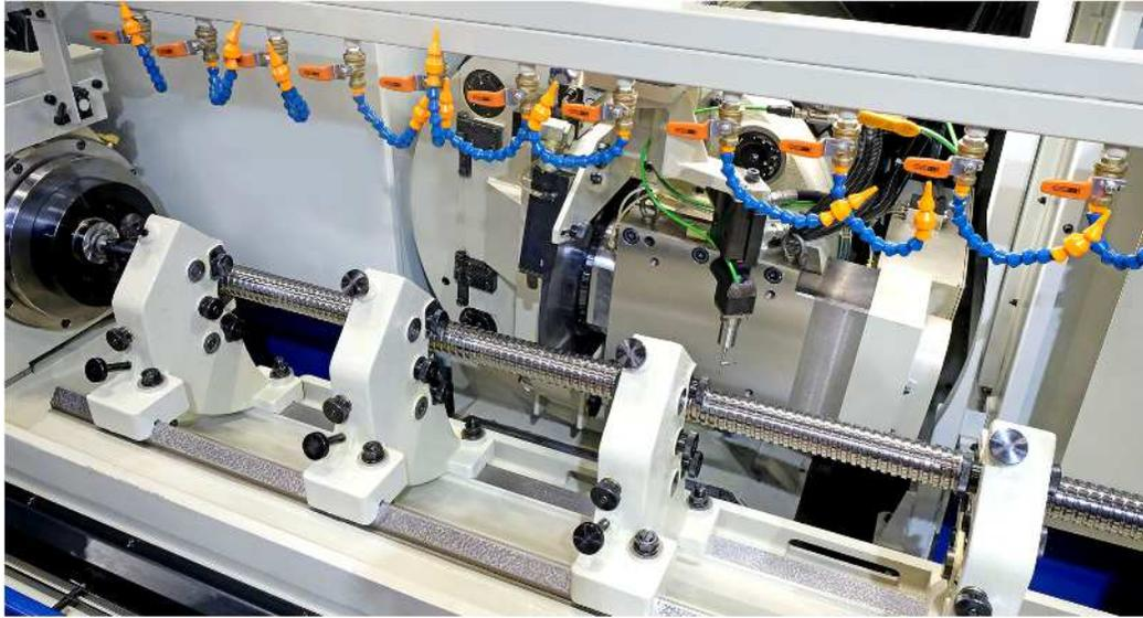
ワーク主軸回転数は従来機の2倍、砥石軸回転数は同3倍、テーブル早送り速度は同4倍と大幅に性能アップしました。ワーク主軸回転数の向上は加工時間の短縮に直結します。また、テーブル早送り速度が向上したことで、片側研削時の戻り時間を短縮することができます。
