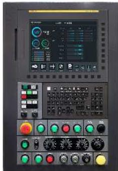
制御装置は最新のHMI(Human Machine Interface)を搭載したFANUC 31i-B 15"タッチパネル式LCDを採用しています。ねじ研削ソフトは当社が長年積み上げてきたねじ研削に関するノウハウを集約し、“Gs-MAPS”として新たに生まれ変わりました。一般的なねじ加工であれば、必要な数値の入力・加工動作の選択だけで最適な加工動作が自動で行なえます。操作盤はアナログ式のスイッチ・ダイヤル類を残しました。研削作業における感覚的な操作を考慮しています。
