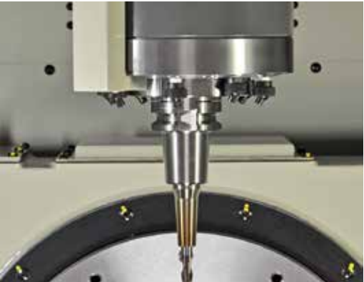
主軸は高速タイプの 25,000min -1 と高トルク・タイプの 15,000min -1 から選択可能。
