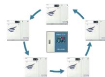
圧力センサにより空気圧力を検知し、コンプレッサを起動・停止させる。起動・停止させるコンプレッサは運転時間が平均化するようにRed-CXが選択する。運転中のコンプレッサが、一定時間運転するとローテーションして運転時間平均化を行う。
