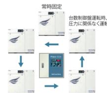
常時起動されるコンプレッサを設定。(常時固定) 設定されたコンプレッサから起動し、連続運転。常時固定コンプレッサ以外はすべての運転パターンが可能。
