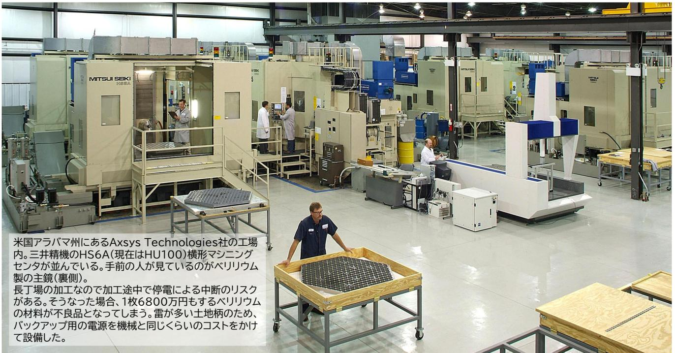
米国アラバマ州にあるAxsys Technologies社の工場内。三井精機のHS6A(現在はHU100)横形マシニングセンタが並んでいる。手前の人が見ているのがベリリウム製の主鏡(裏側)。
